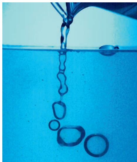
Fig. 1. Photographie sous-marine montrant la génération d'antibulles centimétriques par un jet (on distingue au-dessus du niveau d'eau le bec verseur du bécher). La frontière foncée, autour de chaque antibulle, traduit la présence d'un film d'air.
